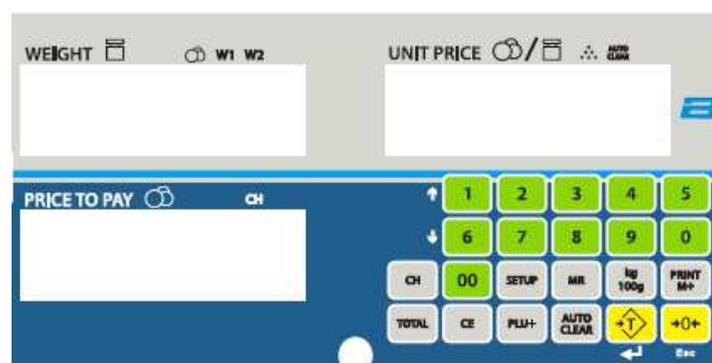
Im Fenster für **Gewicht** werden Pfeile angezeigt, wenn die Waage auf null steht oder ein Nettogewicht anzeigt (sofern vorher ein Tarawert eingegeben wurde). Pfeile werden auch angezeigt, sofern die Waage stabil ist.
