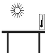
Evite extremos de temperatura. No la coloque en la luz directa del sol ni cerca de aberturas de aire acondicionado.
