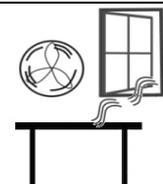
No la coloque cerca ventanas abiertas, aberturas de aire acondicionado o ventiladores que pueden causar lecturas inestables.
