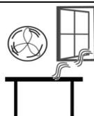
Évitez les mouvements de l'air, tels que des ventilateurs ou l'ouverture des portes. Ne placez pas près d'ouvertures de fenêtres ou de climatisation d'air ce qui pourrait causer des lectures instables.
