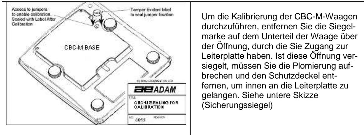
Um die Kalibrierung der CBC-M-Waagen durchzuführen, entfernen Sie die Siegelmarke auf dem Unterteil der Waage über der Öffnung, durch die Sie Zugang zur Leiterplatte haben. Ist diese Öffnung versiegelt, müssen Sie die Plomberung aufbrechen und den Schutzdeckel entfernen, um innen an die Leiterplatte zu gelangen. Siehe untere Skizze (Sicherungssiegel)
