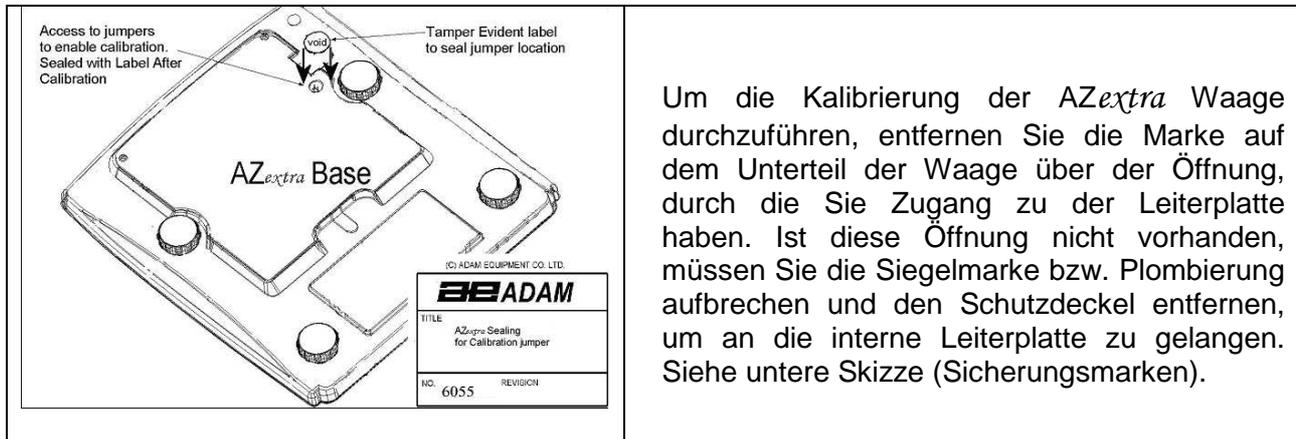
Um die Kalibrierung der *AZextra* Waage durchzuführen, entfernen Sie die Marke auf dem Unterteil der Waage über der Öffnung, durch die Sie Zugang zu der Leiterplatte haben. Ist diese Öffnung nicht vorhanden, müssen Sie die Siegelmarke bzw. Plombierung aufbrechen und den Schutzdeckel entfernen, um an die interne Leiterplatte zu gelangen. Siehe untere Skizze (Sicherungsmarken).
