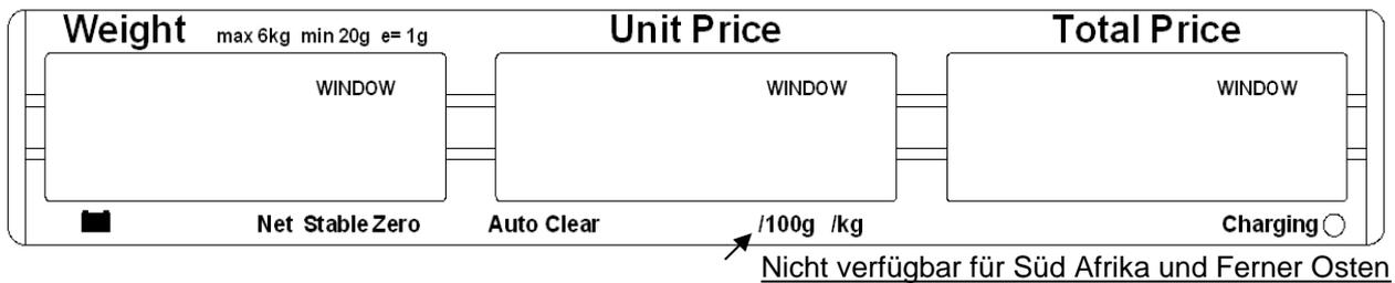
In der Anzeige **Gewicht** erscheinen Pfeile um anzuzeigen, ob die Waage auf Null steht, oder ob ein Nettogewicht angezeigt wird (wenn ein Tarawert eingetragen worden ist). Es zeigt auch an, ob die Waage stabil ist.
