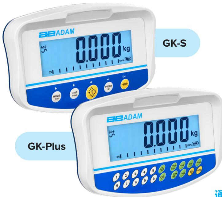
多功能 GK-S 和 GK-Plus 称重显示器具有多种智能功能, 提供直观的用户界面、带 40 毫米大数字的明亮显示屏以及快速结果。带有变色显示屏的内置检重功能可让用户轻松查看样品是高于、低于还是达到设定目标。GK-S 采用更简单的 5 按钮界面, 而 GK-Plus 则采用全数字键盘, 可在同一指示器上执行多种应用 (检重计数、百分比称量、净重/总重称量和动态称量)。这些称重显示器采用坚固的 ABS 塑料外壳, 坚固耐用, 易于清洁。两款称重显示器均配有壁挂支架, 安装方便、安全。
