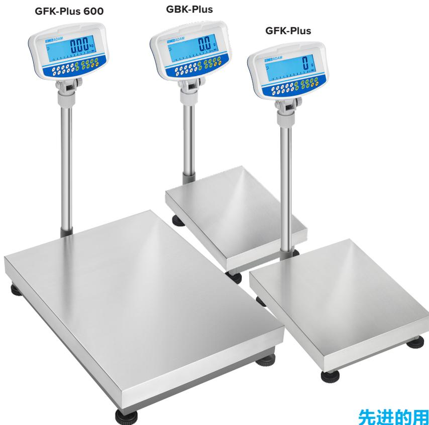
GBK-Plus 和 GFK-Plus 台式和落地式检重秤的设计可满足严格的工业应用要求。GBK-Plus 和 GFK-Plus 配有液晶背光显示屏, 40毫米字高数显和量程跟踪进度条显示, 易于读数。检测称量速度极快, 因为显示屏可变色, 快速显示样品重量低于 (黄色)、高于 (红色) 还是在 (绿色) 预设限值范围内。先进的全数字键盘简化了检重限值的设定, 并且能自由选择的样本大小 (1:1,600,000内部超高计数分辨率) 使零件计数快速、简便、准确。304 级不锈钢秤盘提供了足够大的测量台面。GBK-Plus 和 GFK-Plus 均标配有立杆, 可根据需要安装称重仪表。
